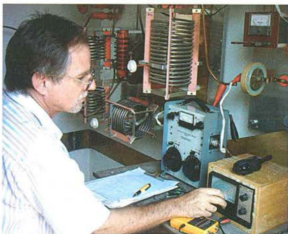
Ajuste do diplexador com monopolo dobrado.
