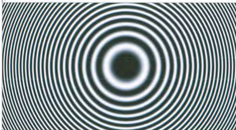
Fig. 2 - Imagem "zone plate" usada no critério TOV.
