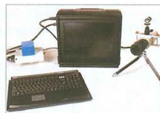
Fig. 1 - Sistema específico de câmera para capturar imagens de filmes e projetores eletrônicos. Ela captura sub-regiões da imagem diretamente da tela, dando uma resolução total de 7000 x 3800 pixels na captura total.
