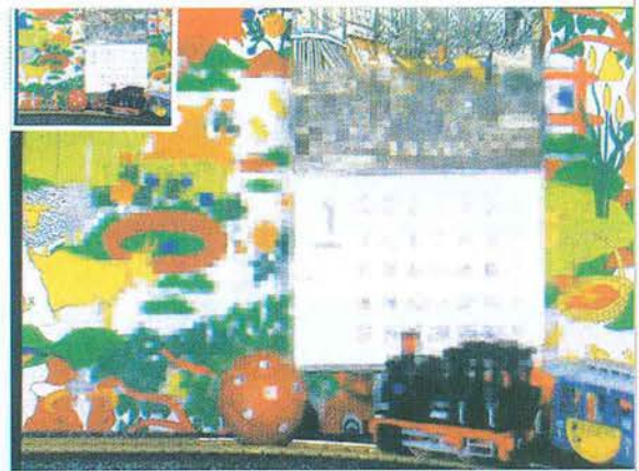
Fig. 8 - Remoção dos coeficientes AC (a inserção mostra que se reduz a visibilidade do efeito mosaico com o tamanho do quadro)
