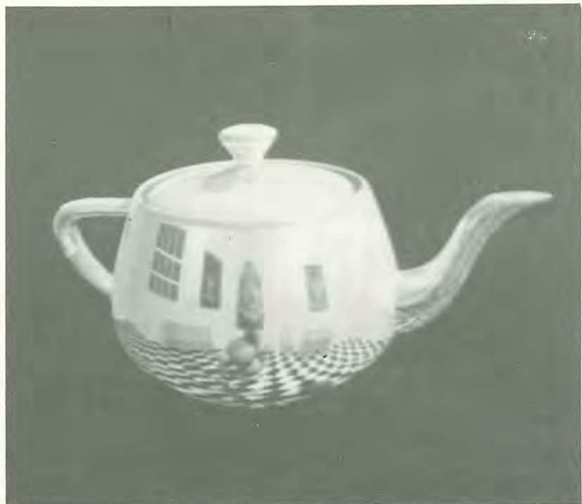
A figura mostra a técnica de reflectance mapping sendo utilizada para refletir no teapot o ambiente de uma sala.
