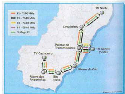
Fig. 3- Rede de microondas bidirecional, normalmente utilizada para tráfego de áudio e vídeo.
