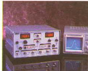
Gerador de Varredura e Marcas (SWEEP)
