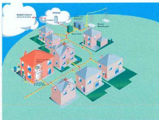
figura 2 - Diagrama da tecnologia DPL (Extraído do site da NORWEB)
