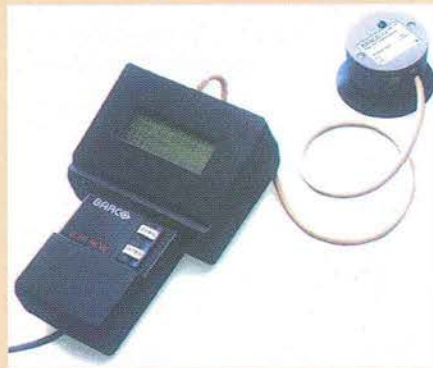
figura 8 - Ponta de prova se ter certeza de que as imagens serão impressas de acordo com as cores do catálogo de amostras.
