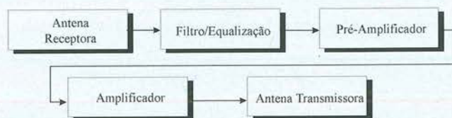
Figura 2: diagrama esquemático do beambender.
