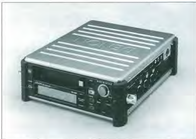
DN-80R da Denon: o primeiro gravador minidisco portátil profissional magneto-óptico
