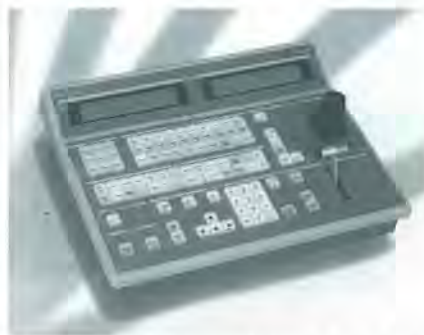
MF-3300 Multiplex Digital Image Processor da For-A: um DVE com vários efeitos como pintura e mosaico
