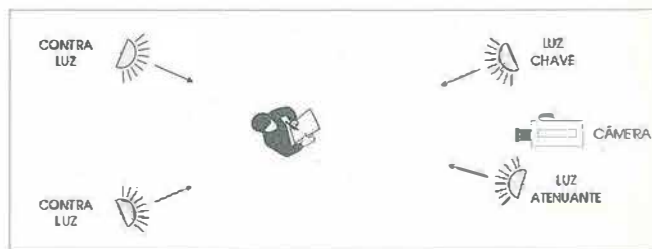
Figura 5: duas fontes de contra-luz, uma chave e uma atenuante
