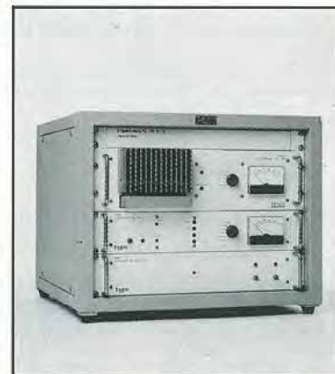
Transmissor de FM totalmente transistorizado, com 50 Watts de potência.
