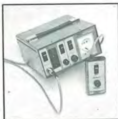
Fonte de 110/220V com "dimmer" e controle remoto.
