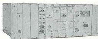
Radio-enlace de micro- onda de 2,5 GHz (TX)
