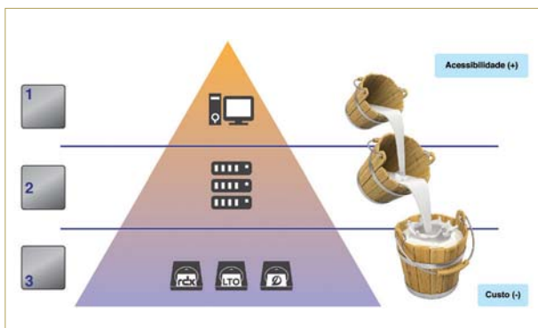
Gráfico 3: Esquema representando a infraestrutura de um sistema de MAM Fonte: Autores
